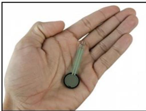
Figura 3. Sensor de Força FSR402
